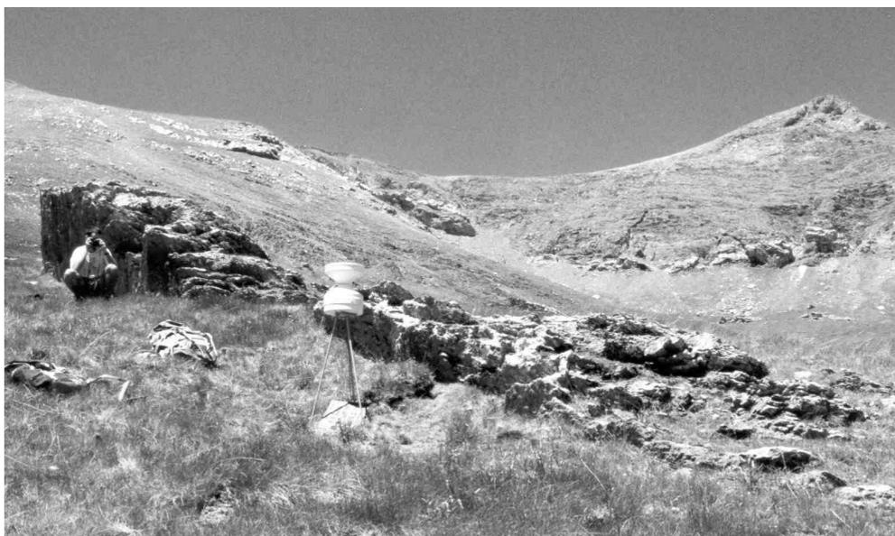
**Figura 2.4.- Pluviógrafo automático Campbell en Corva, con placa solar en su base.**
