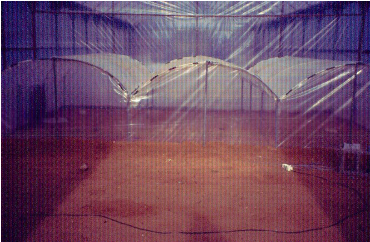
Figura 5.1 Detalle del invernadero a escala construido en el interior de un invernadero mayor con el objetivo de evitar el efecto del viento exterior.
