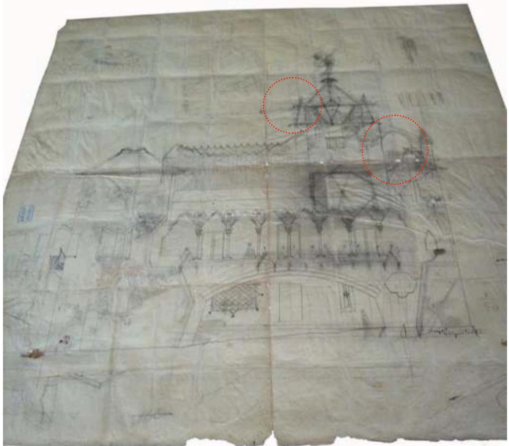
3-29: AJ/CB/011 (Els Pallaresos: AJ, s.f.). Ensayo de alzado de la fachada posterior a los campos. Dibujo a tinta y lápiz sobre papel de dimensiones 65 x 75 centímetros, a escala 1/50. En rojo se señalan las barandillas de la torre, y el arco de la escalera exterior.
