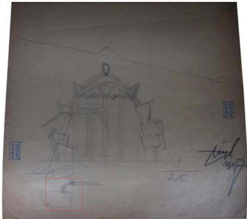
5-27: AJ/CB/101 (Els Pallaresos: AJ; 1917). Detalle en alzado de puerta de acceso a la prensa. No se produce diferenciación entre la piedra que subraya la jamba y el muro. En el alzado las piedras se dibujan forzando la perspectiva, poniendo así de manifiesto el grosor de las mismas.
