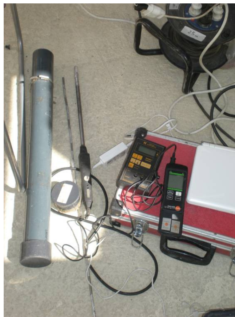
Ampollas para analítica de gases (izquierda) y aparato experimental: sonda de temperatura PT-100 y termo manómetro de campo (derecha).
