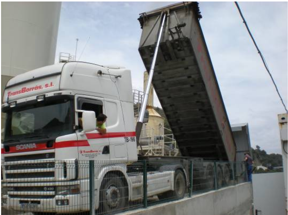
Proceso de descarga de fangos en la tolva
