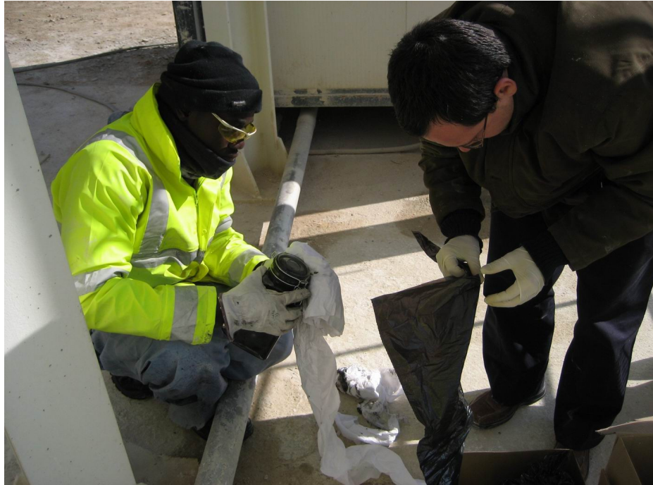
Fase de pruebas inicial. Toma de muestras del lodo de entrada
