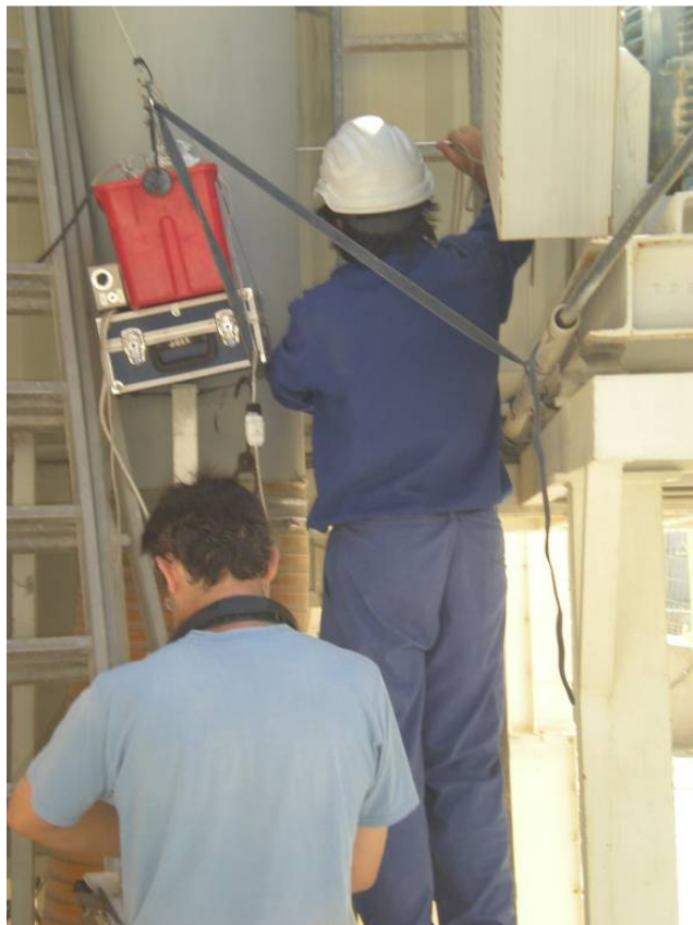
Proceso de toma de muestras antes del scrubber
