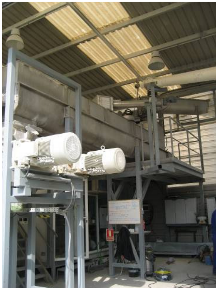
Nuevos reactores de mezcla (imagen octubre 2008). Incremento capacidad.
