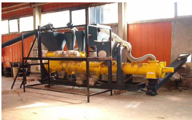
Figura 3.2 Planta móvil de tratamiento de residuos peligrosos (marpol y colas de destilación de petróleo) basado en reactor tipo MID-MIX [Yunirisk, 2011]
