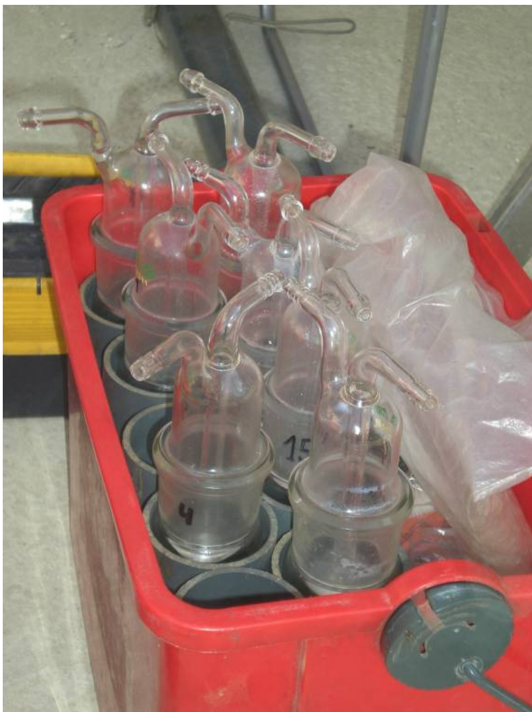
Ampollas para analítica de gases (izquierda) y aparato experimental: sonda de temperatura PT-100 y termo manómetro de campo (derecha).
