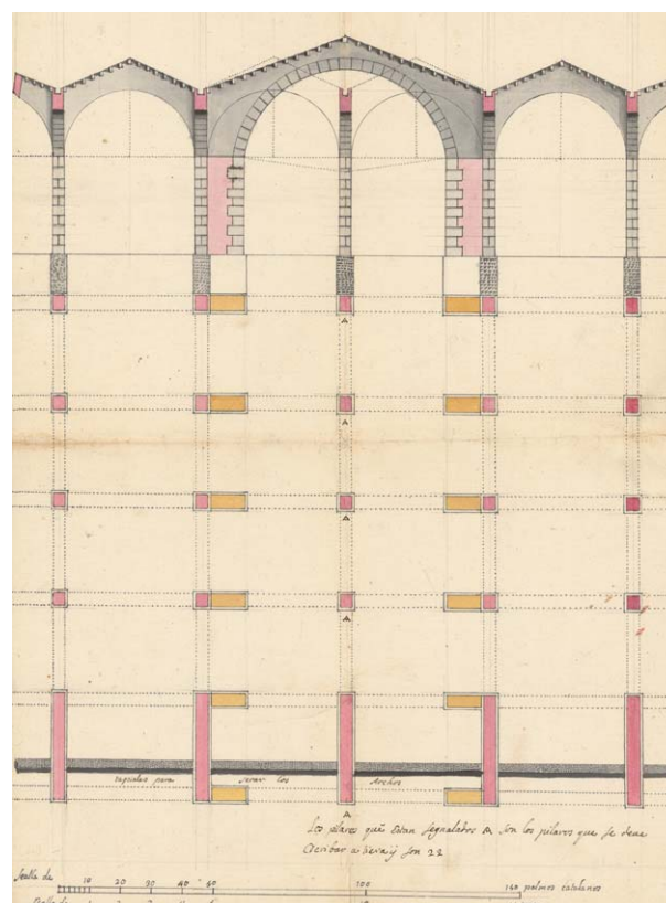
Plànol i secció dibuixades per A. de Res al voltant de 1725 (vegeu els pilars a enderrocar i els contraforts de la nova nau). Mides en Toeses i Pams catalans. (Arxiu museu Marítim de Barcelona).
