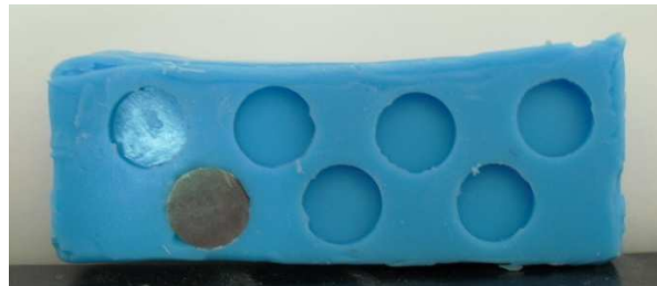
Fig. 5.11: Detalle de la plantilla de silicona para la copia de los discos.
