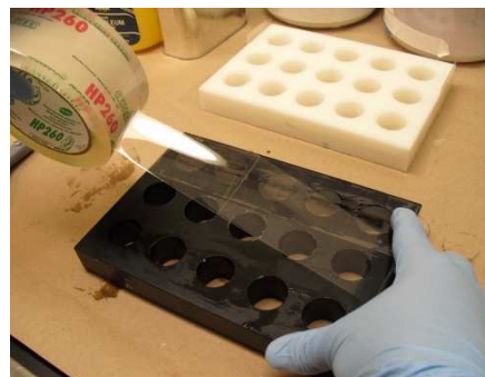
Fig. 5.20: Detalle de colocación de la vaselina en los orificios del molde. Fig. 5.21: Detalle de la colocación de la cinta adhesiva.
