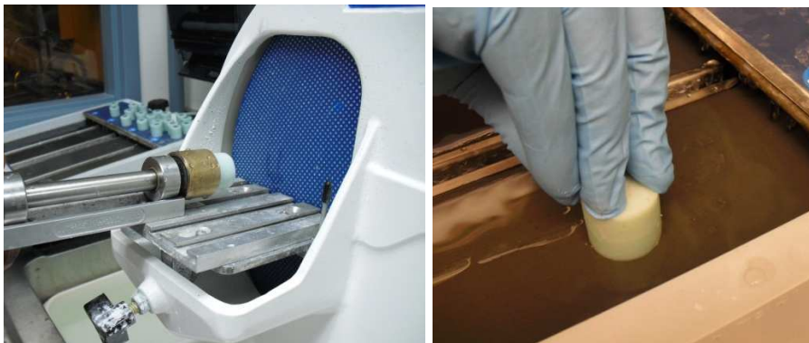
Fig. 5.69: Pulido de la base de las muestras mediante recortadora.
