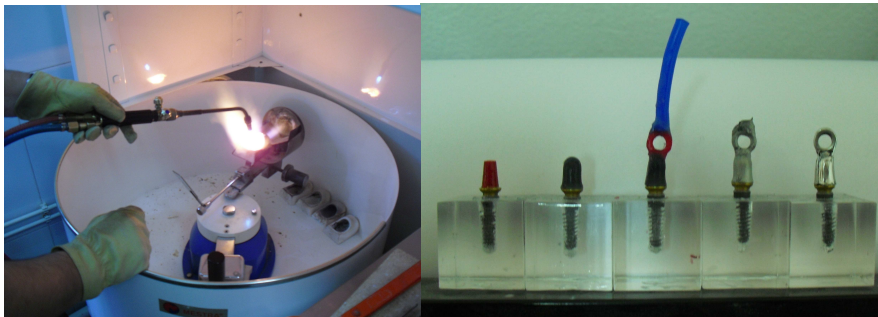
Fig. 5.119: Proceso de colado de las cofias en el laboratorio. Fig. 5.120: Secuencia de confección de una cofia de cromo-cobalto.
