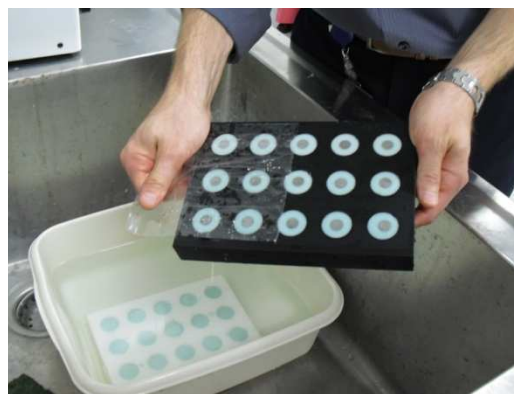
Fig. 5.23: Retirada de la cinta adhesiva una vez fraguada la resina.
