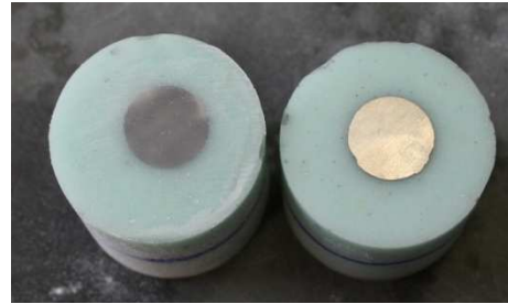
Fig. 5.34: Proceso de arenado de los discos. Fig. 5.35: Aspecto de un disco de titanio después y antes de arenar.
