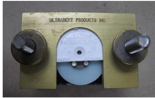
Fig. 5.72: Detalle de la muestra tras la colocación del primer cemento. Fig. 5.73: Muestra preparada para alojar el tercer agente cementante.
