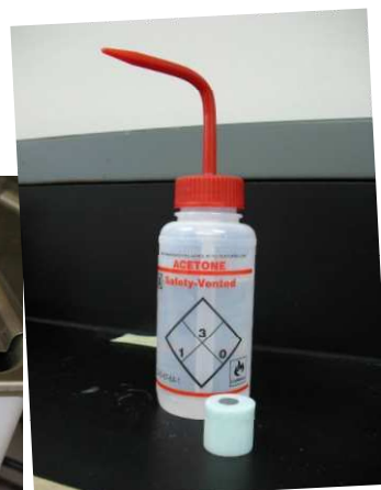
Fig. 5.36: Limpieza de las muestras en ultrasonidos. Fig. 5.37: Colocación de la acetona tras los ultrasonidos.
