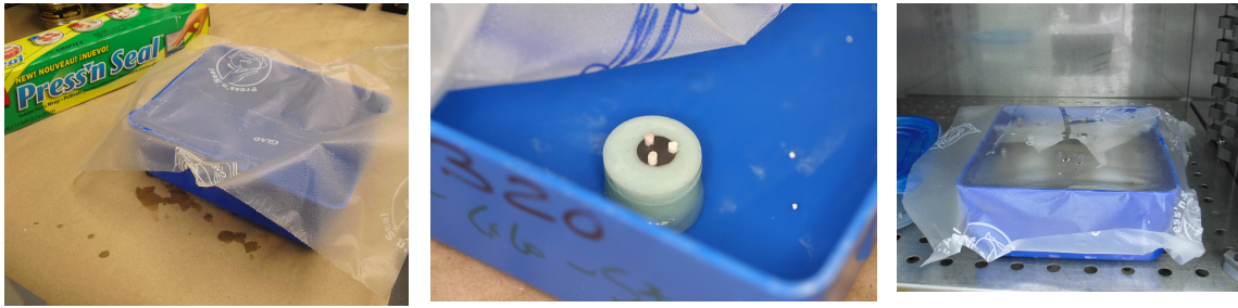
Fig. 5.51: Colocación de la cobertura en el recipiente donde se encontraban las muestras.
