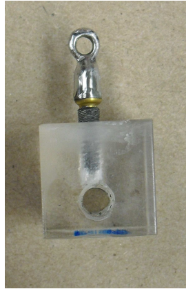
Fig. 5.89: Muestra preparada para el proceso de cementado.
