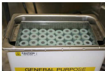
Fig. 5.36: Limpieza de las muestras en ultrasonidos. Fig. 5.37: Colocación de la acetona tras los ultrasonidos.
