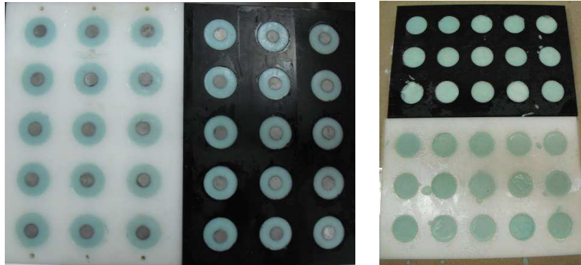
Fig. 5.24: Aspecto de la cara donde están los discos en el molde. Fig. 5.25: Aspecto de la base de la muestra en el molde.
