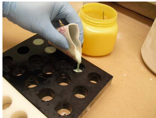
Fig. 5.22: Colocación de la resina en cada uno de los orificios.
