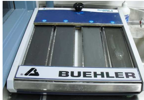
Fig. 5.28: Detalle de la máquina de pulido de los discos de titanio y cromo-cobalto.
