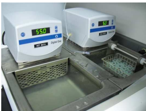
Fig. 5.74: Detalle de la máquina de termociclado antes de iniciar el proceso de envejecimiento. Fig. 5.75: Proceso de termociclado.
