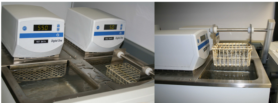
Fig. 5.127: Máquina de termociclado. Fig. 5.128: Movimiento de las muestras entre los dos baños.
