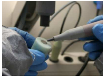
Fig. 5.34: Proceso de arenado de los discos. Fig. 5.35: Aspecto de un disco de titanio después y antes de arenar.
