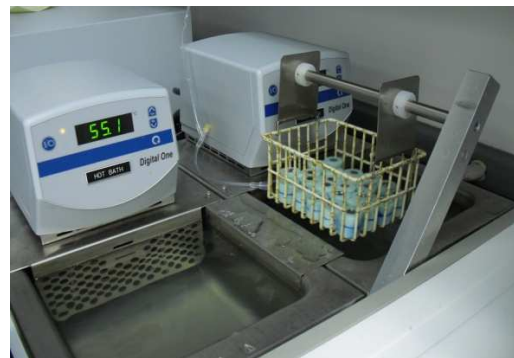
Fig. 5.74: Detalle de la máquina de termociclado antes de iniciar el proceso de envejecimiento. Fig. 5.75: Proceso de termociclado.
