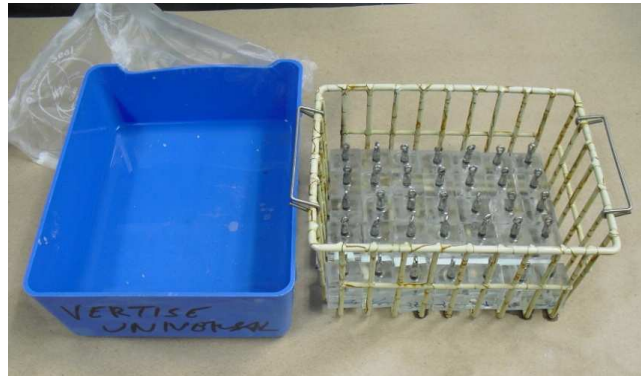
Fig. 5.126: Colocación de las muestras en la cesta para poder ser termocicladas.
