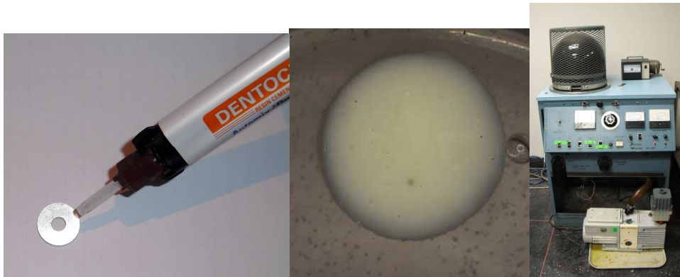
Fig. 5.151: Colocación del cemento en el soporte circular.
