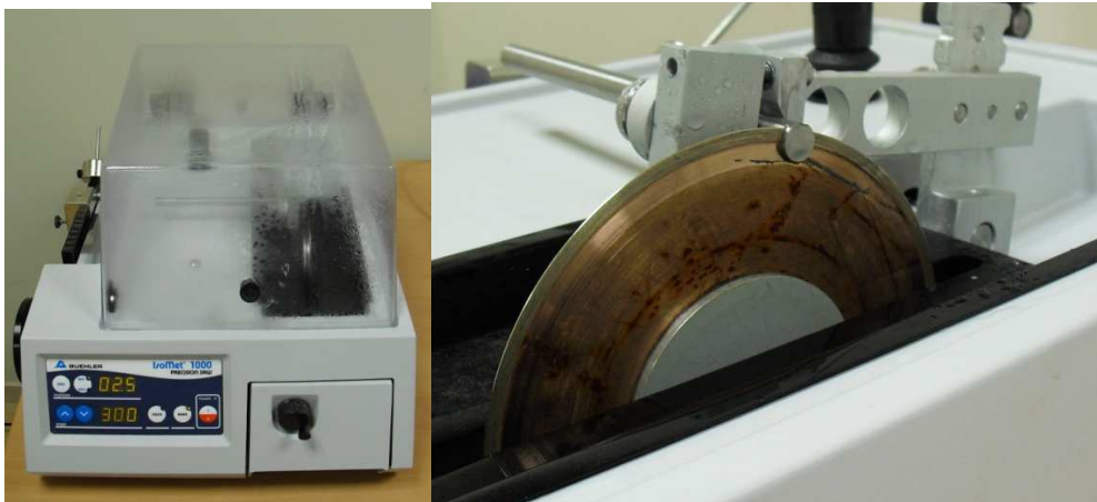
Fig. 5.7: Máquina de corte de precisión utilizada. Fig. 5.8: Detalle del disco de diamante.
