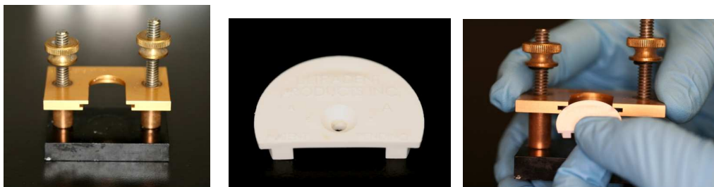
Fig. 5.39: Soporte para sujetar la muestra durante la colocación del cemento.
