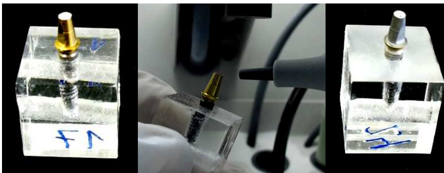
Fig. 5.133: Aspecto del pilar antes del arenado. Fig. 5.134: Proceso de arenado de los pilares. Fig. 5.135: Aspecto del pilar después del arenado.
