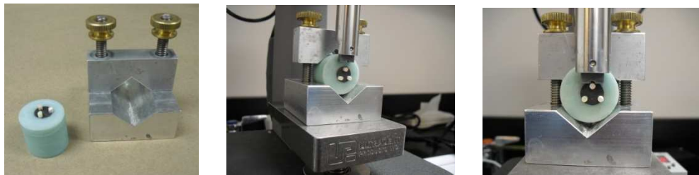
Fig. 5.76: Muestra preparada para colocarla en el soporte para realizar los test de cizalla.
