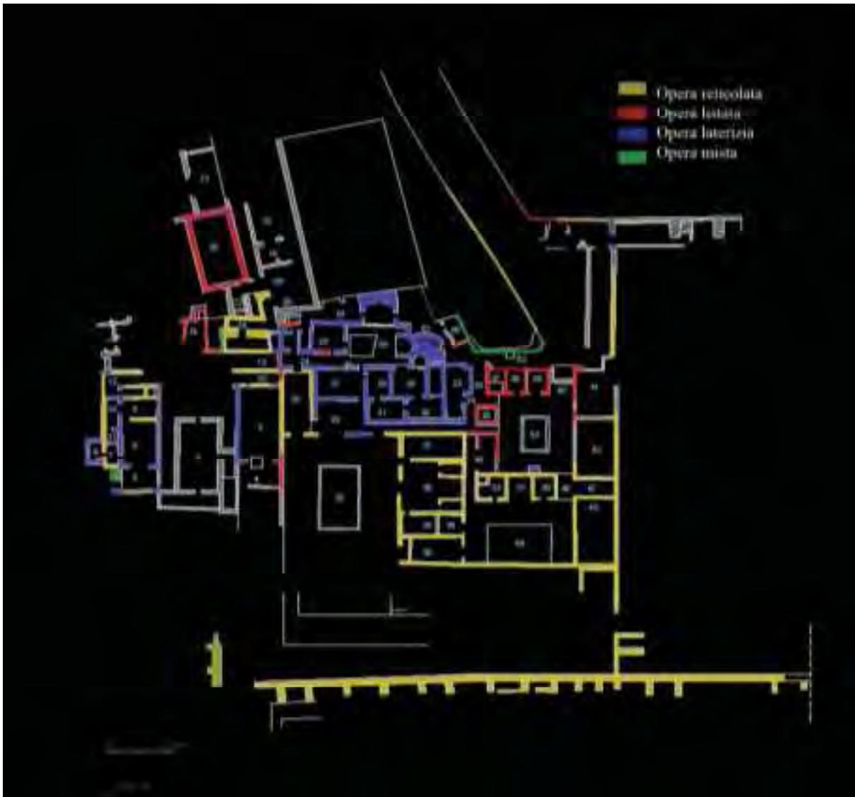
Figura 52 Villa de Livia. Planimetría que muestra las diferentes técnicas constructivas presentes in situ.
