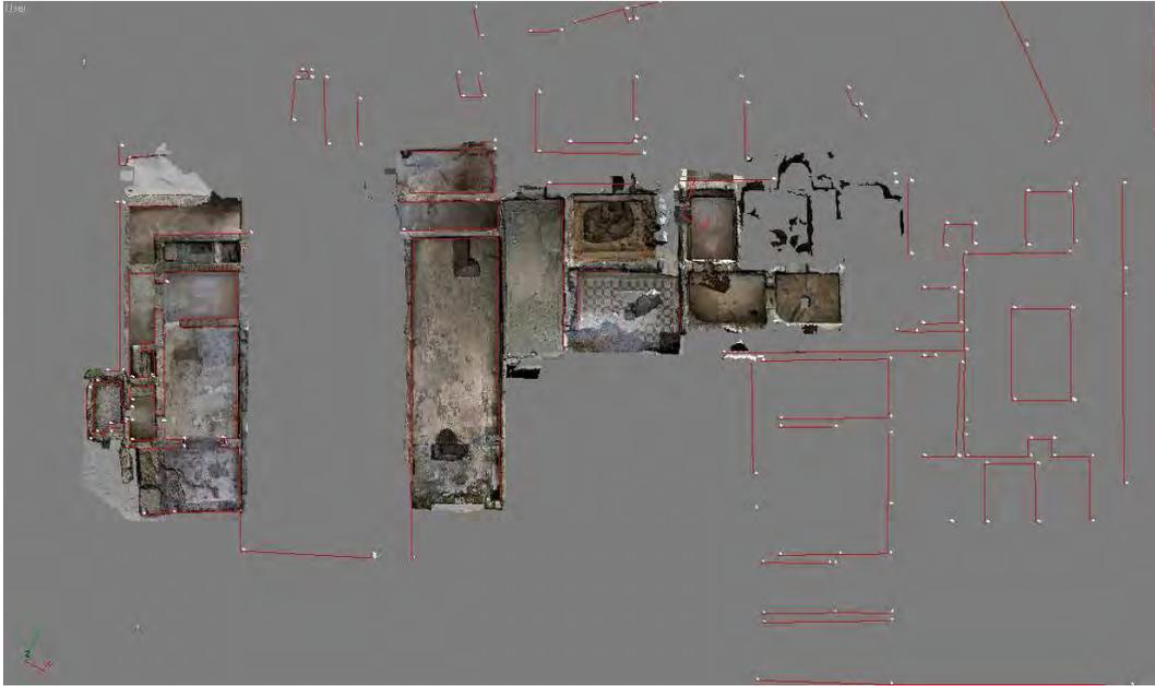
Figura 7. Colocación del modelo 3D sobre los puntos obtenidos con la estación total.
