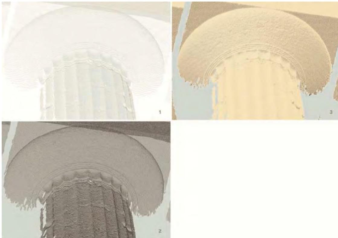
Figura 38. 1. Modelo numérico de un capitel. 2. Modelo numérico poliédrico (mesh). 3. Modelo derivado para la visión realista. Templo de Neptuno, Paestum. Mario Docci.
