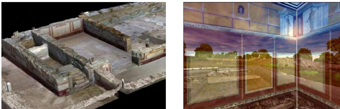
Figura 21. Imagen del estado actual de la Villa, levantamiento con escáner laser. A la derecha reconstrucción en transparencia del estado actual y el estado reconstruido de una de las salas de la Villa.
