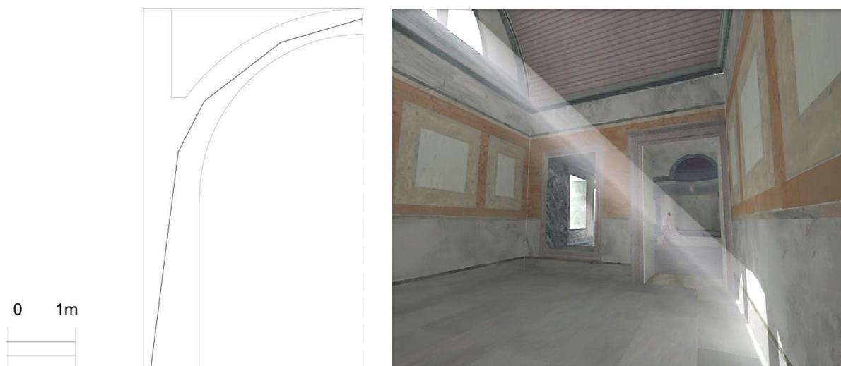
Figura 51. A la derecha estática gráfica para la opción de la bóveda de cañón, a la derecha imagen con la reconstrucción virtual.
