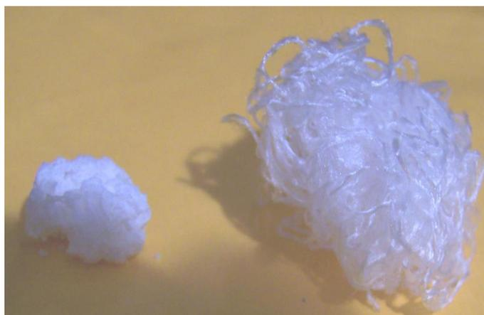
**Fig. 81 Aspecto de la fibra en ausencia (izquierda) y presencia (derecha) de ácido acético.**
