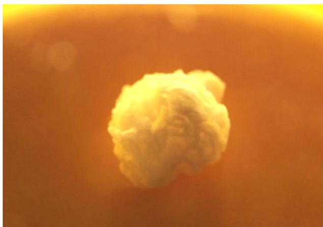
**Fig. 80 Aspecto de la fibra plastificada en ausencia de ácido acético con elevada concentración de fenol**
