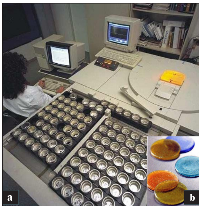
Figura 3.5. a) Sistema de mesura per fluorescència de raigs X Phillips 2400 instal·lat als Serveis Científico-Tècnics de la Universitat de Barcelona (ara Centres Científics i Tecnològics). b) Perles preparades per a l'anàlisi dels elements majoritaris per fluorescència de raigs X.
