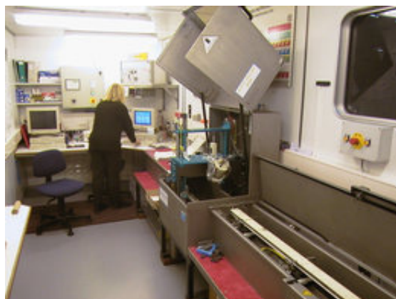
Figura 3.6. Escàner en continu per fluorescència de raigs X de primera generació fabricat per la companyia Avaatech (NIOZ, Holanda) instal·lat a la Universitat de Bremen ( http://www.marum.de ).
