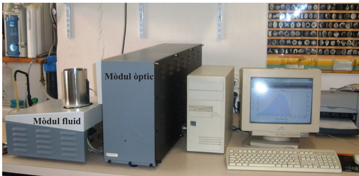
Figura 3.2. Aparell per a l'anàlisi de la mida de gra Coulter LS 100 instal·lat a la Facultat de Geologia de la Universitat de Barcelona, recentment substituït per un Coulter LS 230. Disposa d'un mòdul fluid per on s'introdueix la mostra en fase líquida, un mòdul òptic on es du a terme la mesura i un ordinador des d'on es controlen les mesures i es processen les dades.
