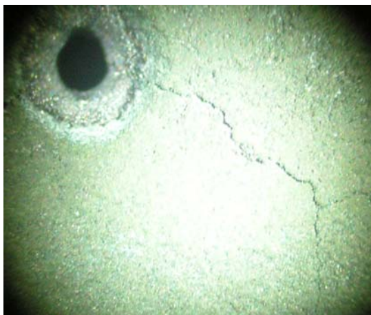
FIGURA 6.4. Aspecto superficial de la muestra acero AISI 1110 con recubrimiento NiCrAlY/Al 2 O 3 (60/40 en peso), nanoestructurado.
